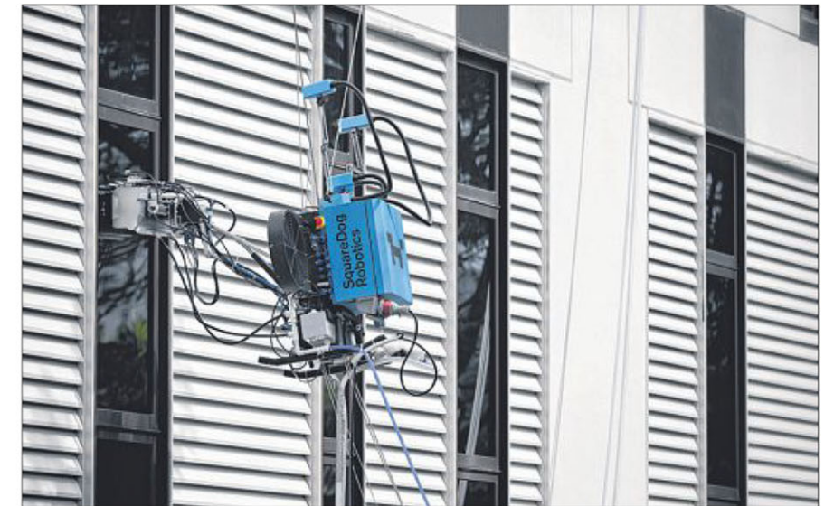
清洗外墙机器人通过遥控操作，能在离地最高180米处展开清洗工作。
