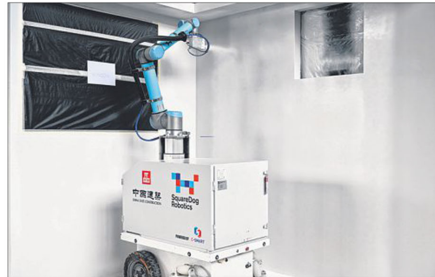
喷漆机器人能够在狭小空间内作业，并确保喷漆素质维持稳定。
