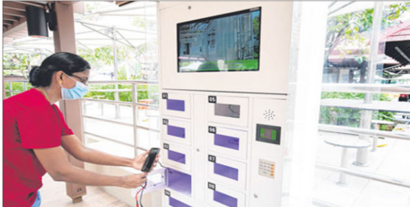
食物垃圾通过厌氧微生物消化后转化为可发电的沼气，进而产生电力，为美食村内的手机充电站供电。
