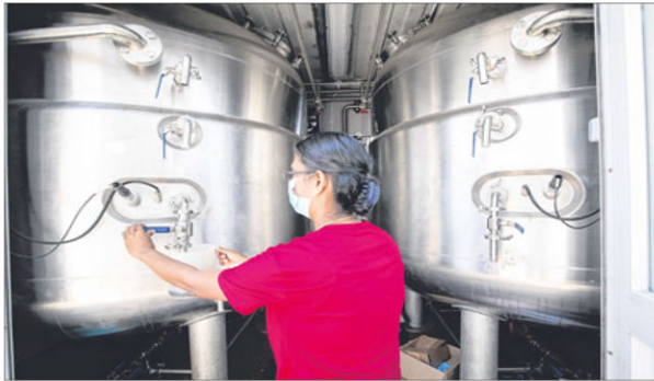
设置在美食村外的厌氧消化器可以将食物垃圾化为沼渣，它能作为肥料来种植植物。图为新加坡国立大学的操作员示范如何从厌氧消化器收集沼渣。
