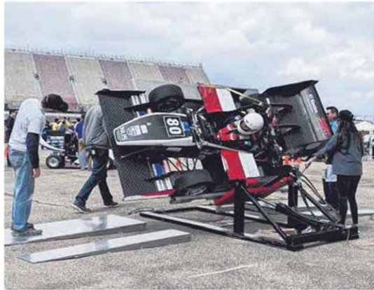
赛车进行倾斜测试，确保机油和冷却剂不会泄漏。
