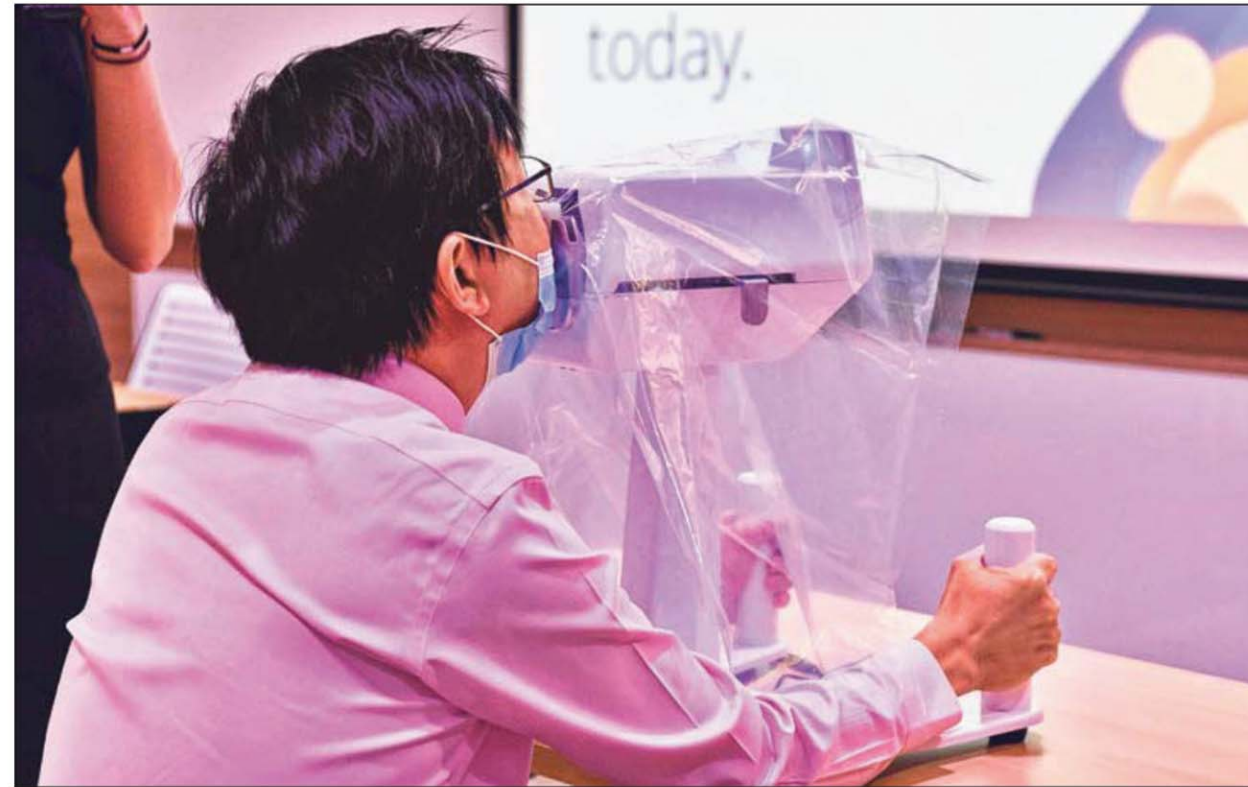
UJIAN SWAB: Dr Tay menunjukkan demonstrasi ujian swab menggunakan robot SwabBot™. SwabBot™ menghasilkan mutu sampel konsisten walaupun terdapat pelbagai bentuk dan saiz hidung. – Foto NCCS
