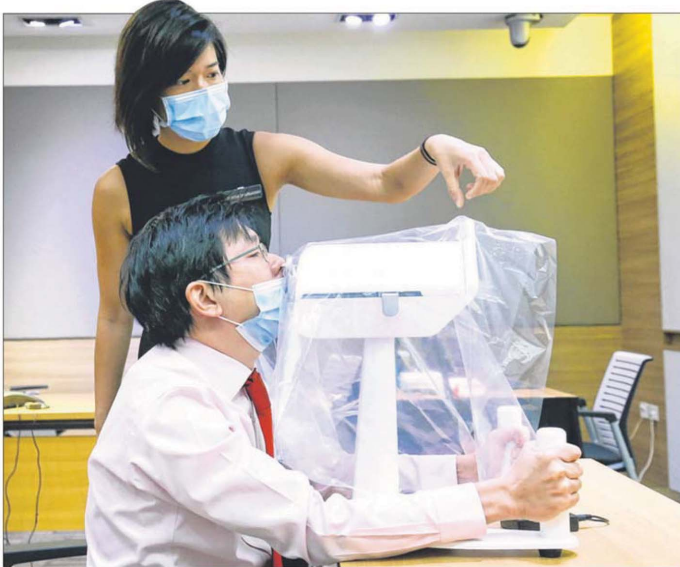
参与研发工作的中央医院与癌症中心外科与肿瘤外科系头颈部部门副顾问医生莉娜（站立者）和中央医院血管外科部门顾问医生郑显宗示范如何操作拭子检测机器人。病患只需将鼻孔靠在机器上，再用下巴轻按前方按钮，机器就会将拭子伸入鼻腔约10公分处采样，过程中若感到不适，可随时移开。（何家俊摄）
