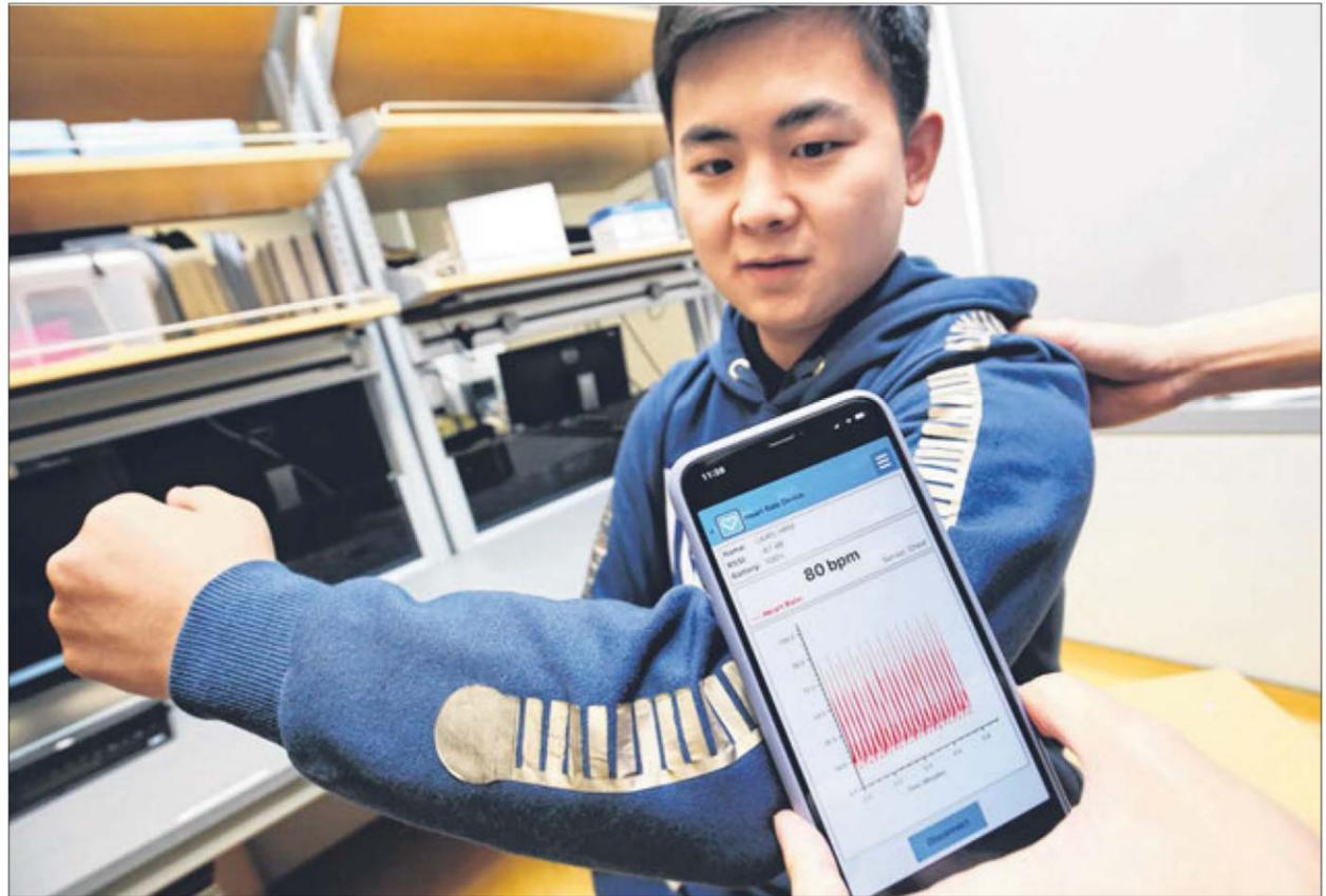
这款用导电布制成的“超材料织物”能大幅缩短信号传播距离，从而延长穿戴式传感器的电池寿命，以及降低信号遭窃听的风险。（萧紫薇摄）
