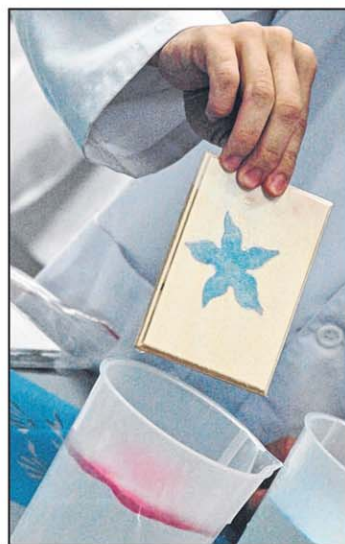
沾上彩色“疏水沙”的部分, 即使刚从水里取出仍然保持干燥。
